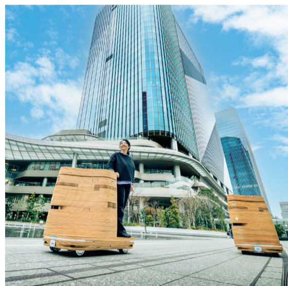
(上)街の中を常に低速で運行している自動走行モビリティ「iino(イイノ)」。人が近づくと自動で減速します。1台の定員は3名、相乗りもOKです。移動手段として使う人もいれば、流れる景色を眺めつつコーヒータイムを楽しむ人も。(右)モビリティの充電スポット。水素由来の電気が活用されています。
