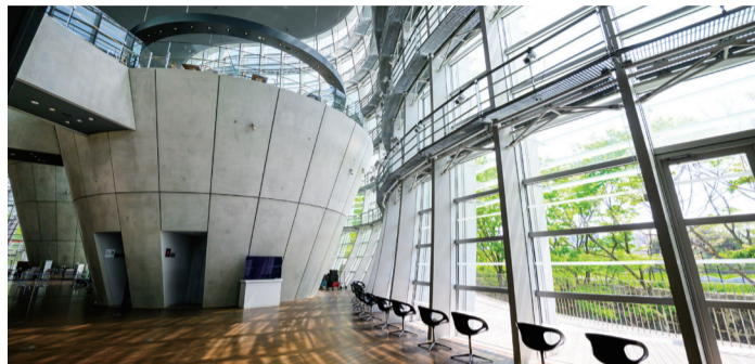
天井高21.6mのアトリウム。美術館としては珍しく、たっぷりと自然光を取り入れるつくり。日差しをやわらげるため、ガラスに水玉模様のフィルムがあしらわれています。
