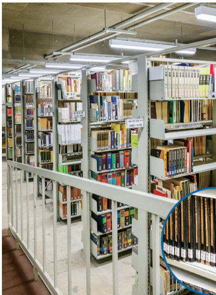
資料の状態を良好に保つため、書庫に13台の除湿器を設置し、書架には結露防止用のボードを敷くなど、さまざまな工夫が。
